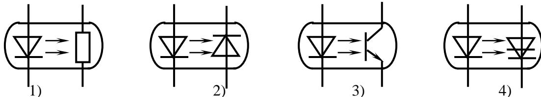
10. Условное графическое обозначение тиристорного оптрана:
