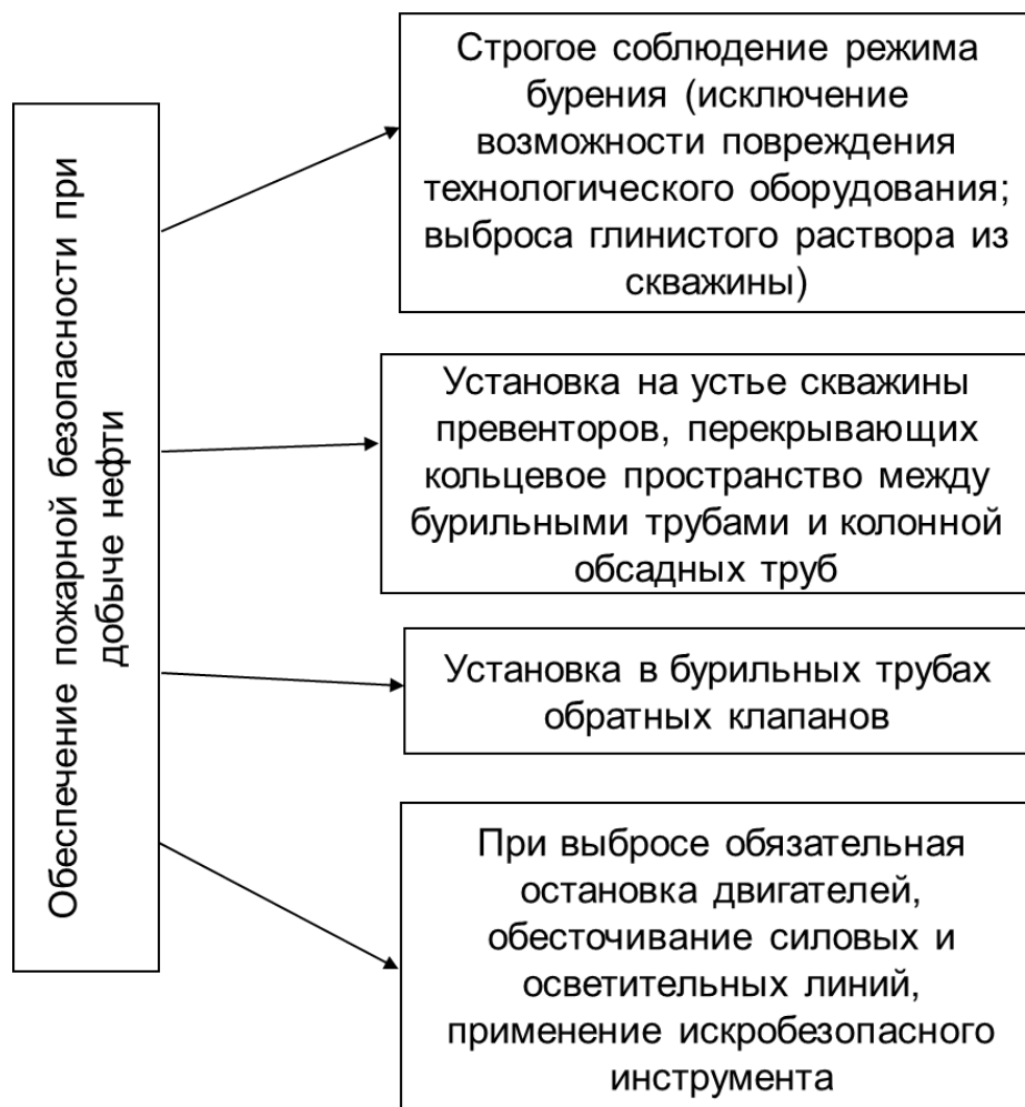
Рис. 4.1. Обеспечение пожарной безопасности при добыче нефти
