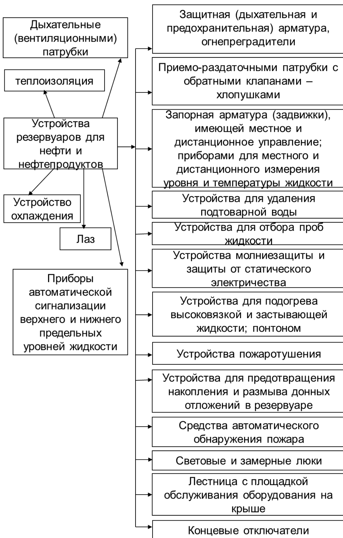
Рис. 5.11. Устройства резервуаров для нефти и нефтепродуктов
