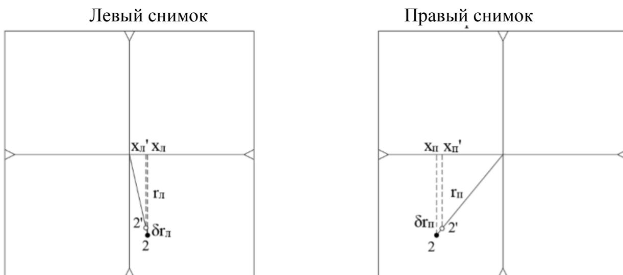
**Рис. 1.3.** Схема определения плановых смещений на снимках.
