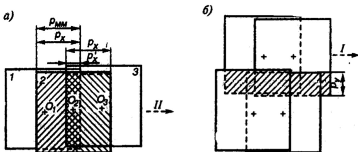
Рис. 2.1. Продольное (а) и поперечное (б) перекрытие аэрофотоснимков
