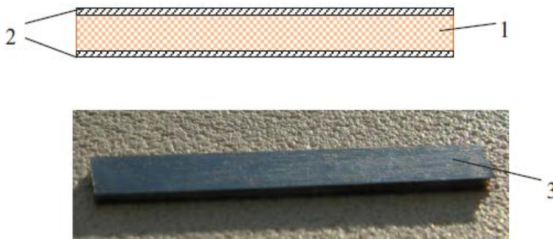
Рис. 1.28. Конструкция магнитоэлектрического датчика: 1 – диэлектрическая прослойка из ЦТС; 2 – магнитные слои аморфного сплава Метглас; 3 – магнитоэлектрический элемент
