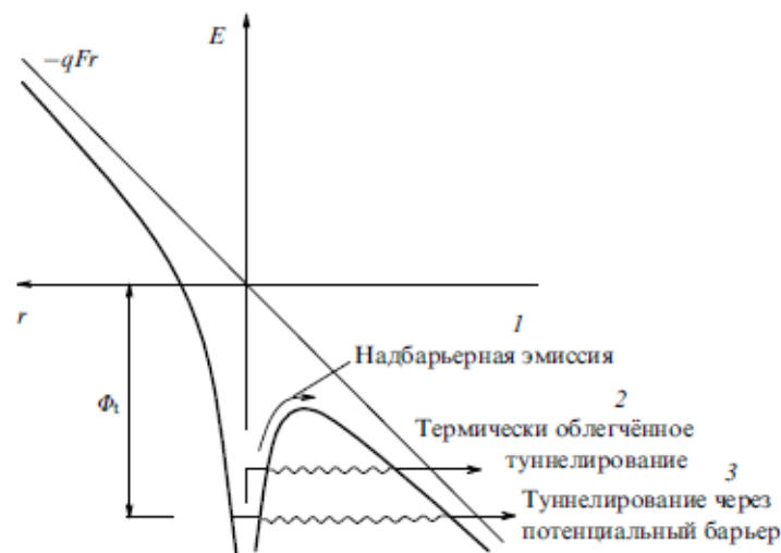
Рис. 2.13. Механизм ионизации по Френкелю: понижение кулоновского потенциала ловушки в электрическом поле. Стрелками указаны возможные механизмы ионизации:
