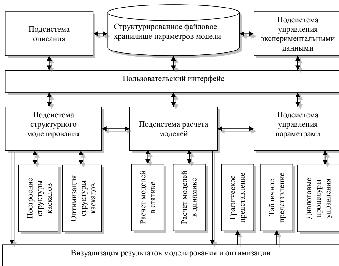
Рис. 2.11. Модульная структура системы структурно-молекулярного моделирования технологических процессов многоцентровой полимеризации
