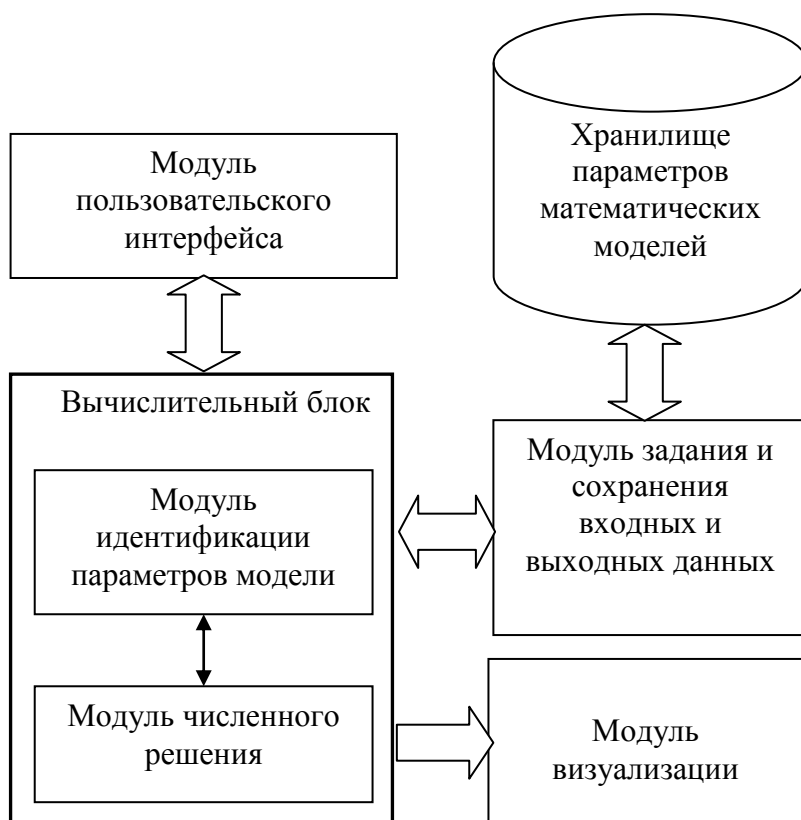
Рис. 4.1 Модульная структура системы многоальтернативного моделирования
