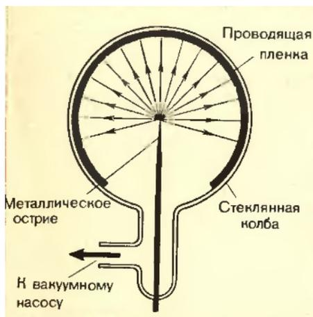
Рис. 2.14. Устройство ионного микроскопа
