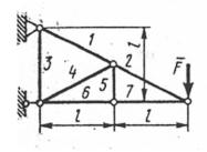
Определить усилие в стержне 6. Сила F = 360 H.
