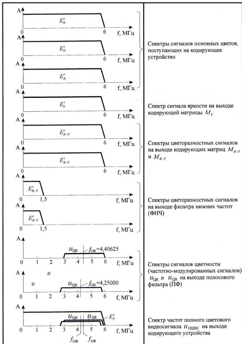
Рис. П2.9. Спектральные преобразования сигналов в кодирующем устройстве SECAM
