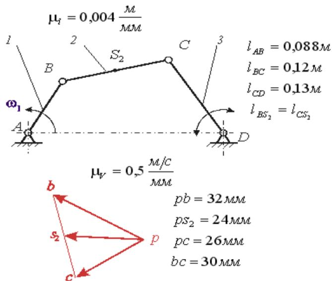
**Вопрос 2.** На рисунке показаны план положений и план скоростей шарнирного четырёхзвенного механизма. Скорость точки  $S_2$  шатуна 2 равна \_\_\_\_\_ м/с (ответ дать с точностью до целых).
