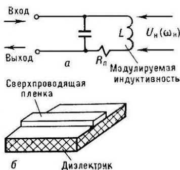
Рис. 6.10. Сверхпроводящий усилитель: a – схема, L – управляемая индуктивность, R_{\text{п}} – сопротивление перехода Джозефсона; b – активный элемент усилителя
