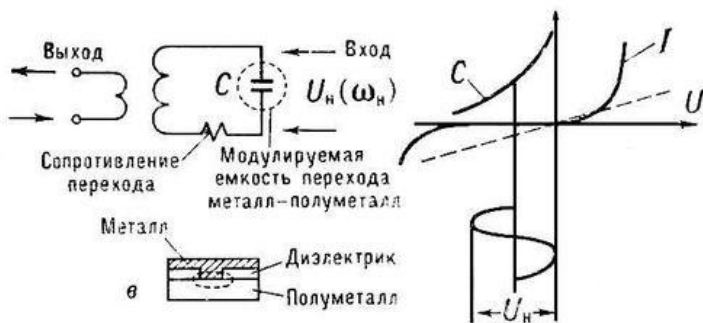
Рис. 6.9. Низкотемпературный параметрический усилитель: а - эквивалентная схема; б - вольтамперная характеристика перехода металл-полуметалл ( U - напряжение, I - ток) и зависимость его ёмкости C от напряжения при T < 80 К; пунктиром показана эта же характеристика при комнатной температуре (300 К); U_H и \omega_H - напряжение и частота накачки; в - переход металл-полуметалл - активный элемент усилителя
