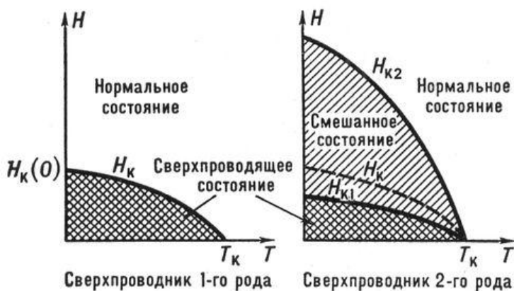
Рис. 6.5. Фазовая диаграмма для сверхпроводников 1-го и 2-го рода
