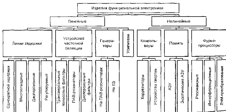
Рис. 2.11. Классификация устройств функциональной акустоэлектроники
