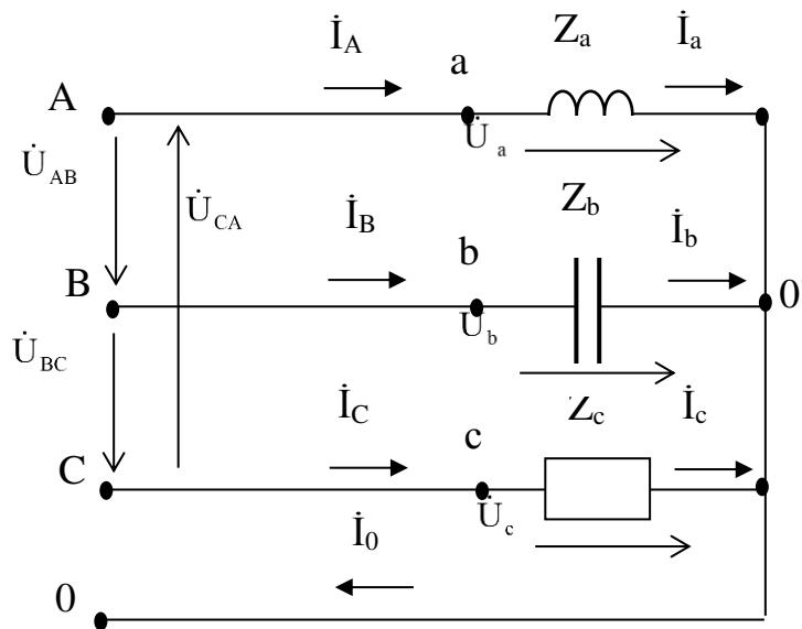
**8.** В трехфазную электрическую сеть с линейным напряжением 380 В включен трехфазный приемник. Дано: мощность фаз приемника:  $S_a=5,2$  кВА;  $Q_b=4,5$  кВАр;  $P_c=2,6$  кВт;  $\phi_a=\phi_b=\phi_c=-60^\circ$ . Изобразите схему замещения цепи. Определите все мощности трехфазного приемника, фазные токи и сопротивления фаз. Постройте векторную диаграмму.
