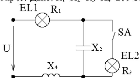
**6.** Рассчитать линейные и фазные токи и напряжения приемников. Построить топографические диаграммы, совмещенные с векторными диаграммами токов.
