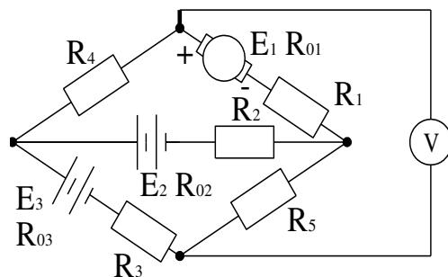
$$R_4=15 \text{ Ом}; R_5=20 \text{ Ом}; R_V \rightarrow \infty.$$
