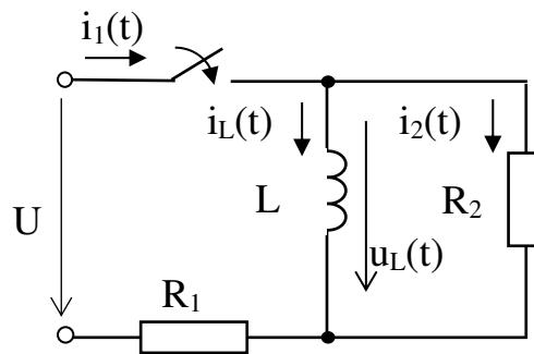
**10.** Катушка, индуктивность которой равна  $0,12 \text{ Гн}$  и сопротивление  $1 \text{ Ом}$ , включается на постоянное напряжение  $30 \text{ В}$ . Чему равна постоянная времени этой катушки? С какой скоростью нарастает ток в начальный момент? Чему равно установившееся значение тока?
