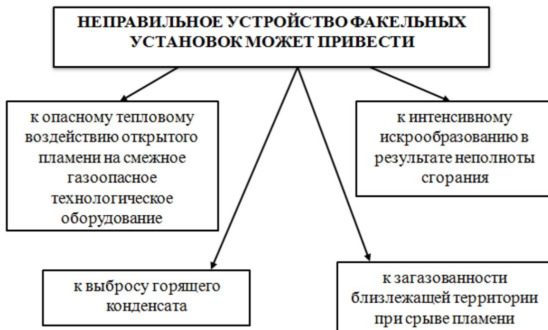
Рис. 7.7. Перечень негативных последствий неправильного устройства факельных установок
