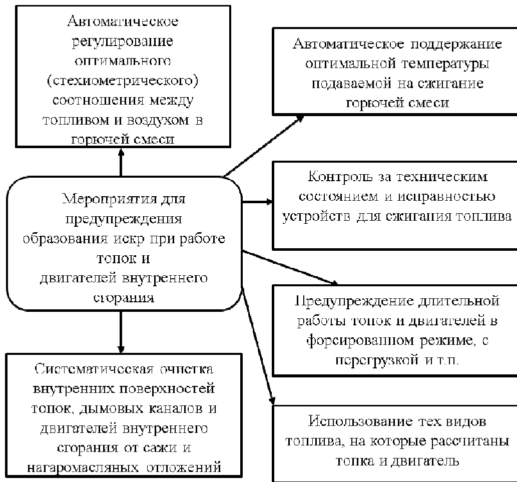
Рис. 7.10. Перечень мероприятий, направленных на исключение искрообразования в топках и двигателях
