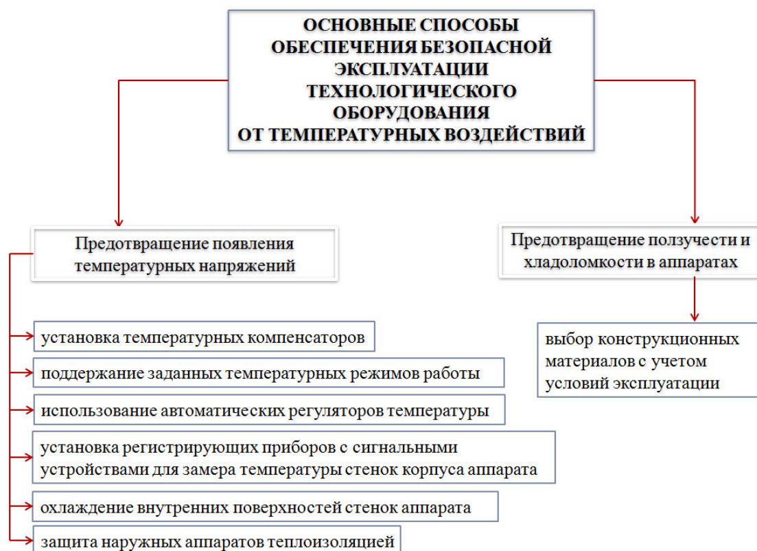
Рис. 5.7. Основные способы защиты технологического оборудования от температурных воздействий
