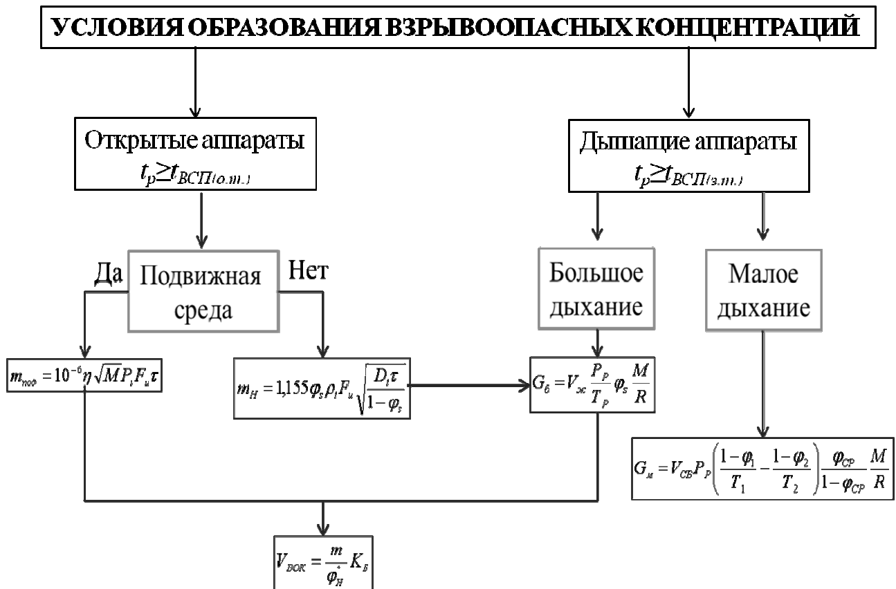
Рис. 4.1. Условие образования взрывопожароопасных концентраций: m_{\text{пар}} – масса пара, который испарится с поверхности жидкости в условиях работы системы вентиляции, кг; \eta – коэффициент, который зависит от скорости воздушного потока и рабочей температуры; M – молярная масса жидкости, кг/кмоль; P_s – давление насыщенных паров жидкости при рабочей температуре, Па; F_u – площадь поверхности испарения, \text{м}^2 ; \tau – продолжительность испарения; \phi_s – концентрация, %; \rho_l – плотность при рабочей температуре, \text{кг}/\text{м}^3 ; D_l – коэффициент молекулярной диффузии; V_{\text{ж}} – объем жидкости, находящейся в аппарате, \text{м}^3 ; P_p – рабочее давление, Па; T_p – рабочая температура, К; V_{\text{св}} – свободный объем аппарата, \text{м}^3 ; K_b – коэффициент безопасности, допускается принимать равным 2; t_p – рабочая температура аппарата, ^{\circ}\text{C} ; t_{\text{ВСП(о.м.)}} – температура вспышки открытого тигля, ^{\circ}\text{C} ; t_{\text{ВСП(з.м.)}} – температура вспышки закрытого тигля, ^{\circ}\text{C} [3]
