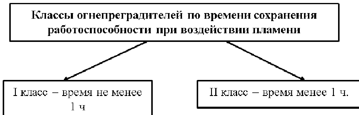
Рис. 8.9. Классы огнепреградителей по времени сохранения работоспособности при воздействии пламени [7]
