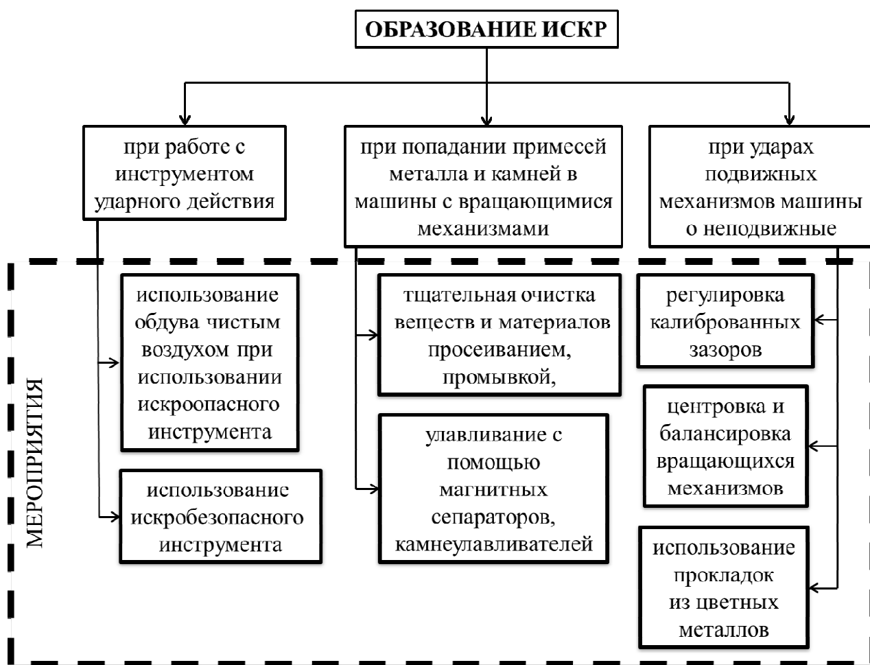
Рис. 7.12. Причины образования искр и мероприятия, направленные на их исключение
