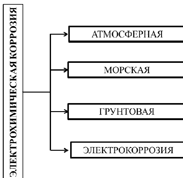
Рис. 5.5. Виды электрохимической коррозии
