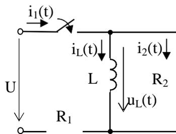
10. Катушка, индуктивность которой равна  $0,12 \text{ Гн}$  и сопротивление  $1 \text{ Ом}$ , включается на постоянное напряжение  $30 \text{ В}$ . Чему равна постоянная времени этой катушки? С какой скоростью нарастает ток в начальный момент? Чему равно установившееся значение тока?
