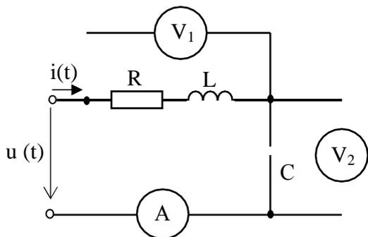
8. Определить показания приборов электромагнитной системы в цепи, схема которой показана на рисунке, записать выражение мгновенного значения тока, если:  $R=50 \text{ Ом}$ ,  $\omega L=10 \text{ Ом}$ ,  $\frac{1}{\omega C}=90 \text{ Ом}$ . На вход
