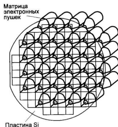
Рис. 4.6. Схема матрицы параллельных электронных пучков для прямого нанесения рисунка на пластину
