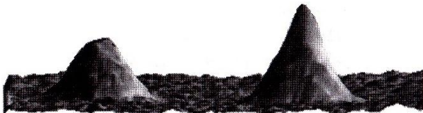
Рис. 6.14. Оксидные островки, сформированные зондовым окислителем кремния в режиме постоянной (слева) и переменной (справа) полярности импульсов тока
