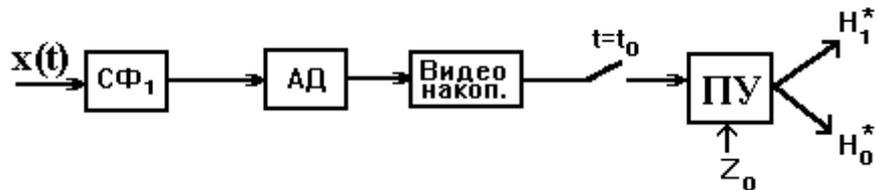
Рис. 3.8. Структурная схема приемника обнаружения с некогерентным накоплением импульсов
