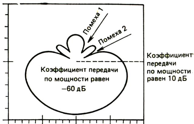
Рис. 16.10. Диаграмма направленности для системы, показанной на рис. 16.9 при мощных помехах, приходящих под углами  $\theta=30^\circ$  и  $\theta=60^\circ$
