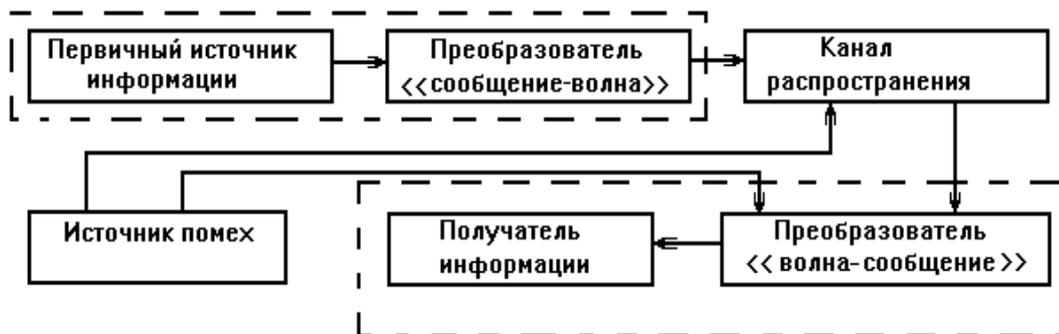
Рис. 1.1. Структурная схема радиотехнической системы
