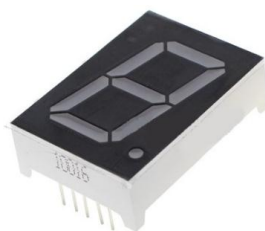
Рис. 8.1. Внешний вид семисегментного светодиодного индикатора TOS-5161AMR-N с общим анодом
