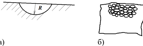
Рис. 2. Образование единичной (а) лунки и серии лунок (б), формирующих микроповерхность
