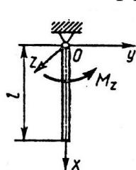
Однородный стержень, масса которого  $m = 8$  кг и длина  $l = 1,5$  м, вращается вокруг оси  $Oz$  под действием пары сил с моментом  $M_z = 12 \cdot \sin(3\pi t/4)$  Н·м. Определить угловое ускорение стержня в момент времени  $t = 2/3$  с.
