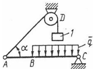
Балка  $AC$  закреплена в шарнире  $C$  и поддерживается в горизонтальном положении веревкой  $AD$ , перекинутой через блок. Определить интенсивность распределенной нагрузки  $q$ , если длины  $BC = 5 \text{ м}$ ,  $AC = 8 \text{ м}$ , угол  $\alpha = 45^\circ$ , а вес груза  $1$  равен 20 Н.
