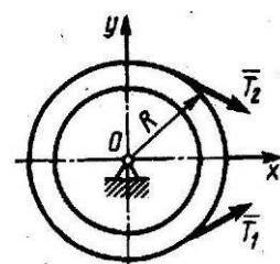
Определить радиус инерции шкива массой  $m = 5$  кг и радиуса  $r = 0,4$  м, если под действием сил натяжения ремня  $T_1 = 2T_2 = 10$  Н он вращается с угловой скоростью  $\omega = 10t$ .
