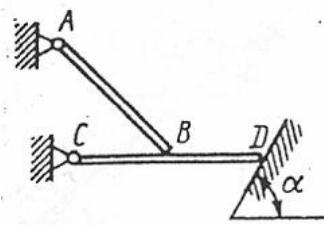
Однородная балка  $AB$ , вес которой 200 Н, свободно опирается в точке  $B$  на горизонтальную балку  $CD$ . Определить, с какой силой балка  $CD$  действует на опорную плоскость в точке  $D$ , если расстояние  $CB = BD$ , угол  $\alpha = 60^\circ$ . Весом балки  $CD$  пренебречь.
