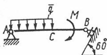
Определить момент  $M$  пары сил, при котором реакция опоры  $B$  равна 250 Н, если интенсивность распределенной нагрузки  $q = 150 \text{ Н/м}$ , размеры  $AC = CB = 2 \text{ м}$ .
