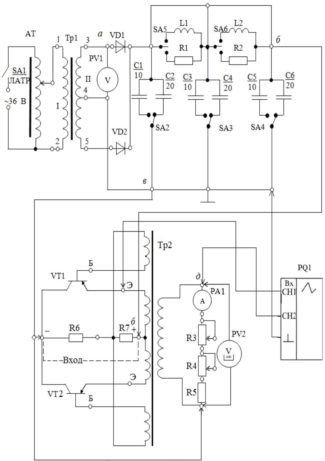
Схема лабораторной установки для проведения измерений параметров
