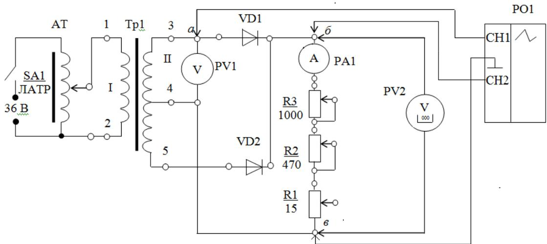
Чему равны частота и коэффициент пульсации на выходе схемы выпрямления, если частота сети равна 50 Гц?
