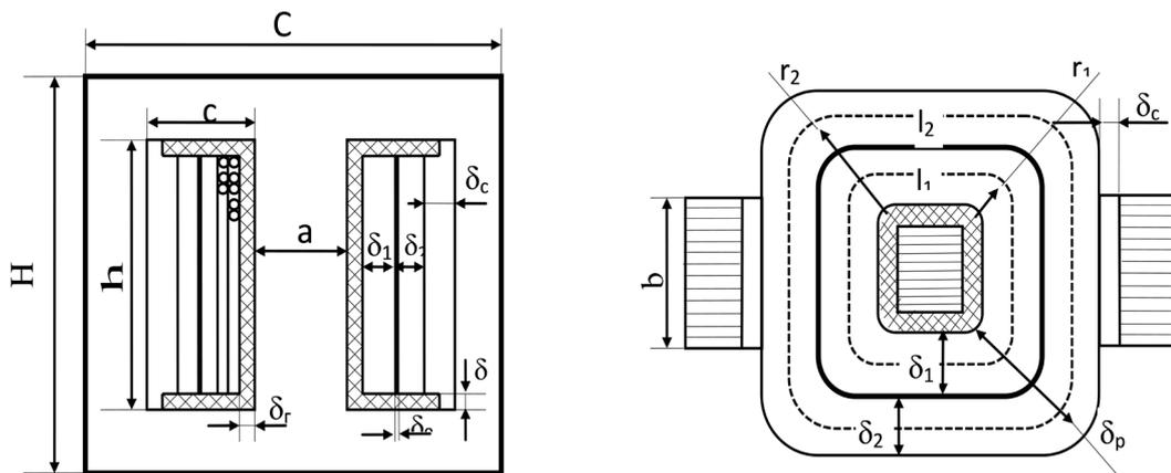
Размещение обмоток на магнитопроводе
