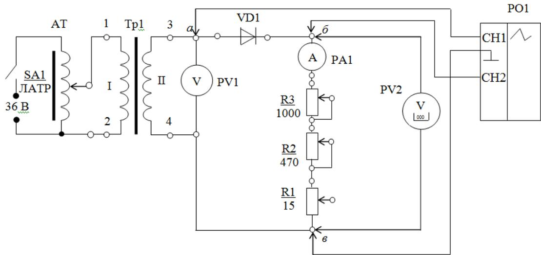
Схема лабораторной установки для проведения исследований
