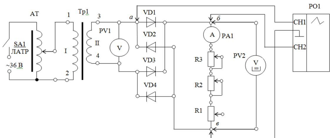
Чему равны частота и коэффициент пульсации на выходе схемы выпрямления, если частота сети равна 50 Гц?
