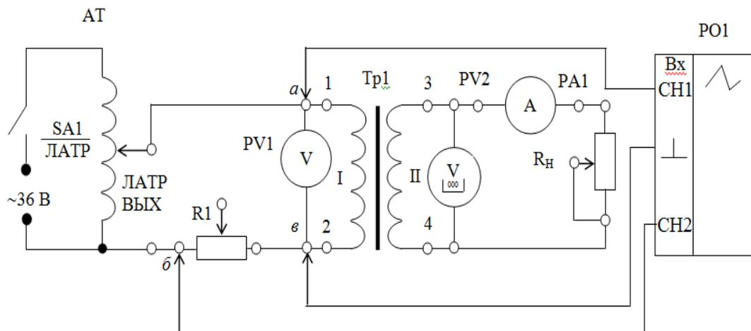
Схема лабораторной установки для проведения исследований силового трансформатора в режиме
