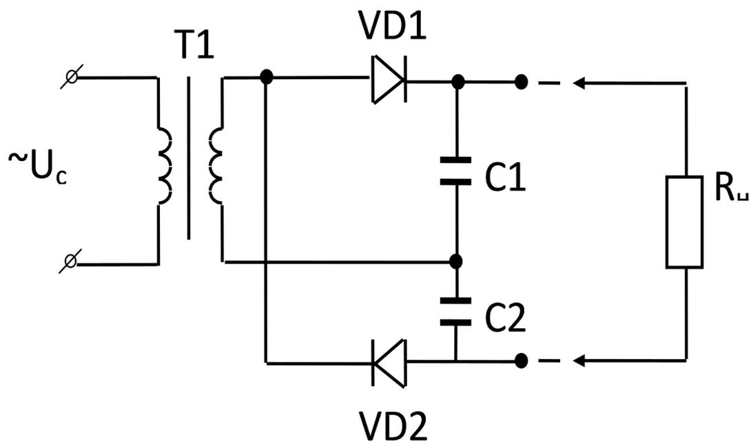
Если амплитуда напряжения сети  $U_c=100\text{В}$ , а коэффициент трансформации трансформатора  $n=1$ , то напряжение на нагрузке будет
