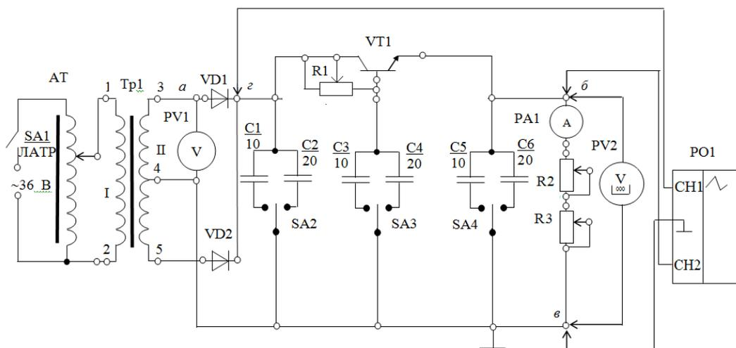
Схема лабораторной установки для проведения исследований
