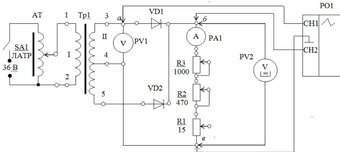
Чему равны частоты гармоник напряжения на выходе схемы выпрямления, если частота сети равна 50 Гц?
