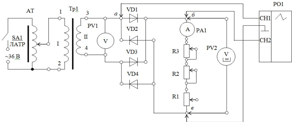
Схема лабораторной установки для проведения исследований
