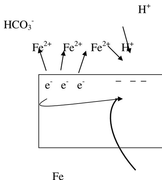
Схема электрохимической коррозии железа в кислой среде
