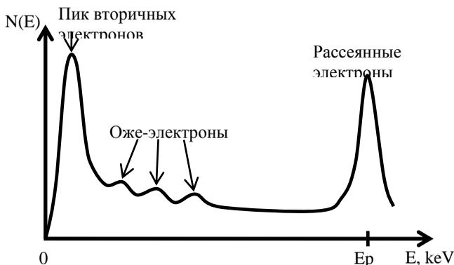
Рис. 2.2. Типичный спектр вторичных, рассеянных и Оже-электронов
