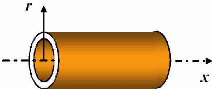
Рис. 3.3. Трубочатый пьезоэлемент
