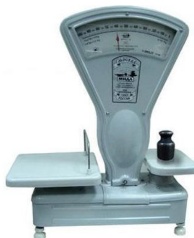
Рисунок 5.3 - Настольные циферблатные весы РН-10Ц13У:
