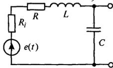
7. Рассчитать емкость последовательного колебательного контура, если резонансная частота контура  $f_0 = 1$  МГц, полоса пропускания  $\Pi = 6$  кГц при сопротивлении потерь  $0,5$  Ом.
