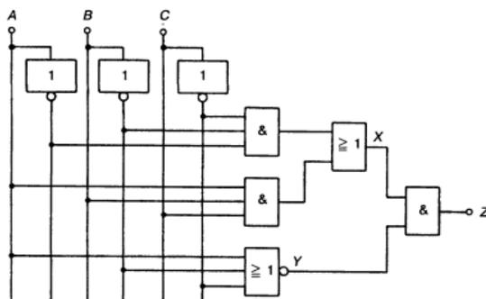
10. Схема работает с ошибками. Таблица результатов тестирования (протокол измерений) приведена на рис. Определите дефектные логические элементы.
