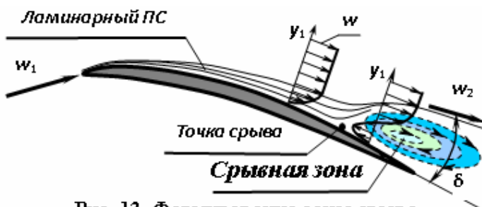
Рис. 13. Формирование зоны срыва потока у поверхности спинки профиля
