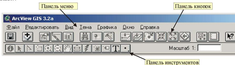
Рис. 8. Панель инструментов
