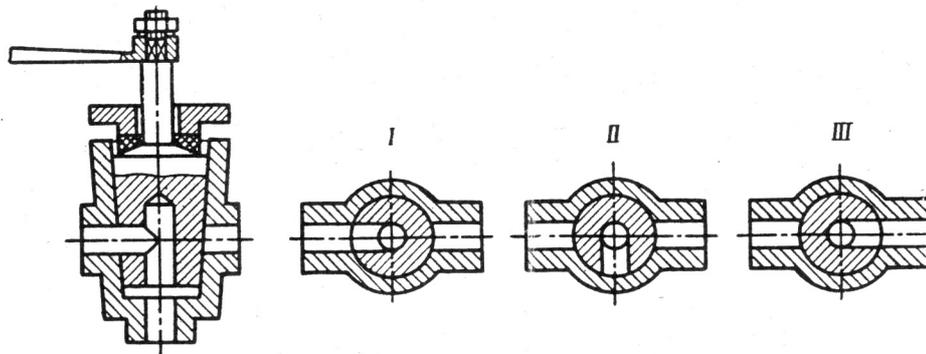
При положении ручки, показанной на схеме, кран открыт. Топливо из основного крана (поз. I) поступает к бензонасосу. При повороте ручки на  $90^\circ$  (поз. II) кран закрыт, подача топлива прекращается. При повороте ручки еще на  $90^\circ$  вправо топливо к насосу поступает из дополнительного бака (поз. III).
