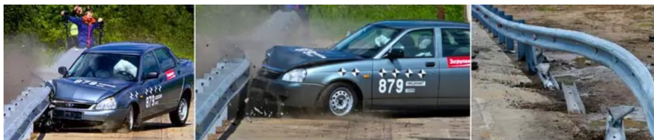
Рис. 4. Столкновение автомобиля с типовым односторонним барьерным ограждением
