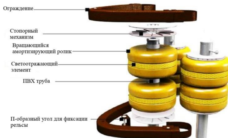
Рис. 2. Устройство роликового ограждения
