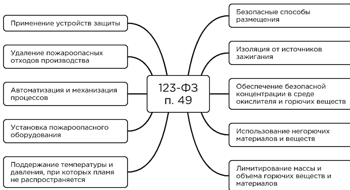
Рис. 1. Способы исключения условий образования горючей среды
