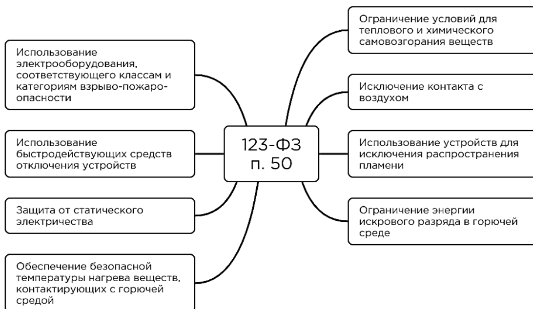
Рис. 2. Способы исключения условий образования в горючей среде (или внесения в нее) источников зажигания
