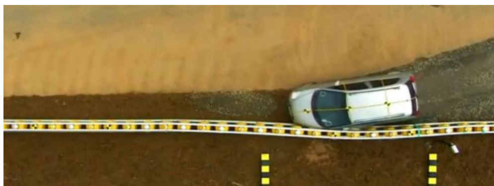
Рис. 5. Столкновение автомобиля с роликовым барьерным ограждением
