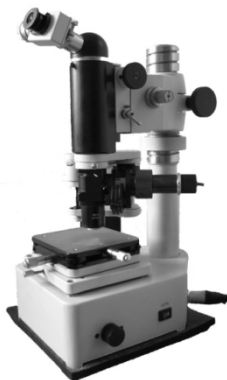
Рис. 6. Общий вид прибора ПМТ-3М
