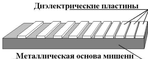
Рис. 3. Вид мишени, используемой для напыления наногранулированных структур металл-диэлектрик
