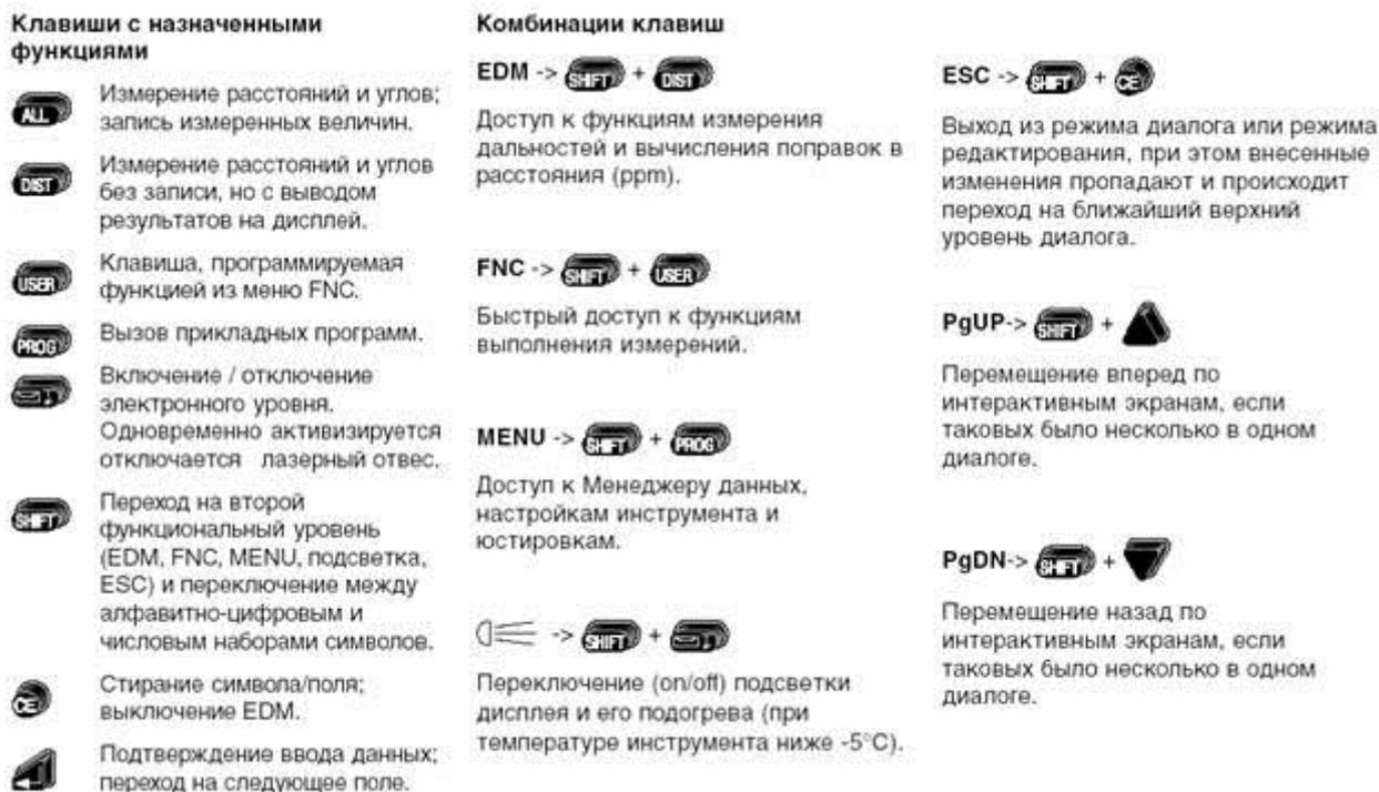
Рис. 3. Назначение клавиш панели управления
