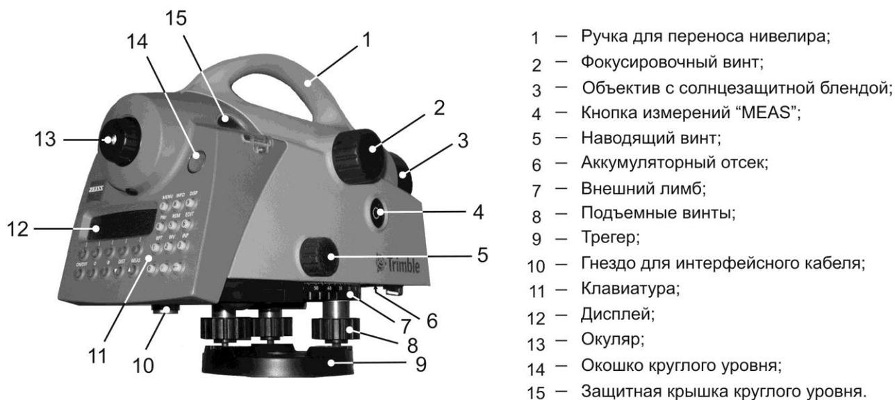
Рис. 34. Общий вид цифрового нивелира DiNi 12
