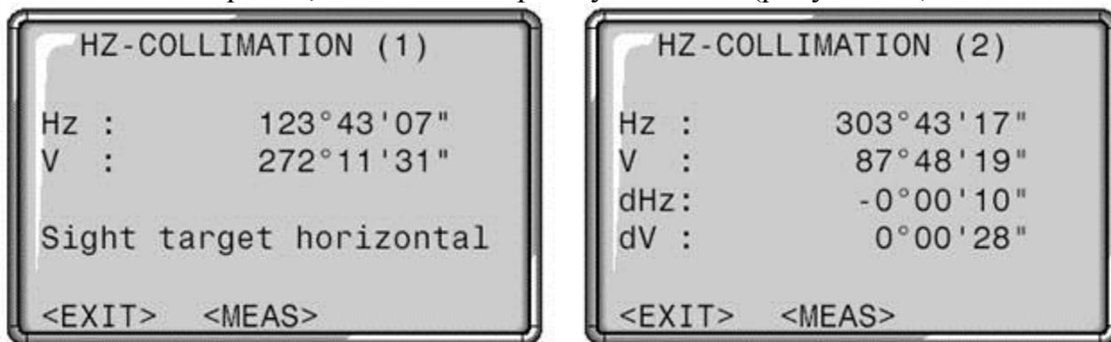
Рис. 23. Отсчёты по горизонтальному кругу при КЛ и КП
