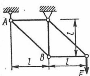
Определить усилие в стержне  $AB$ . Сила  $F = 300$  Н.
