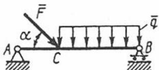
На балку  $AB$  действуют распределенная нагрузка интенсивностью  $q = 2$  Н/м и сила  $F = 6$  Н. Определить реакцию опоры  $B$ , если длина  $AC = \frac{1}{3} AB$ , угол  $\alpha = 45^\circ$ .  $AB = 3$  м.
