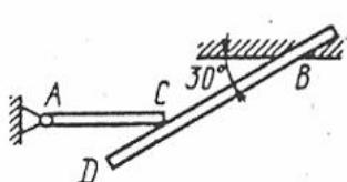
Однородный горизонтальный стержень  $AC$ , вес которого равен 180 Н, свободно опирается в точке  $C$  на балку  $BD$ . Определить реакцию балки  $BD$  на стержень  $AC$ .
