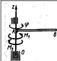
Однородный стержень, масса которого  $m = 2$  кг и длина  $AB = 1$  м, вращается вокруг оси  $Oz$  под действием пары сил с моментом  $M_1$  и момента сил сопротивления  $M_2 = 12$  Н·м по закону  $\varphi = 3t^2$ . Определить модуль момента  $M_1$  приложенной пары сил в момент времени  $t = 1$  с.
