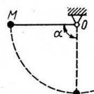
Материальная точка  $M$  массой  $m$  подвешена на нити длиной  $OM = 0,4$  м, отведена на угол  $\alpha = 90^0$  и отпущена без начальной скорости. Определить скорость точки в нижнем положении. (2,8 м/с)
