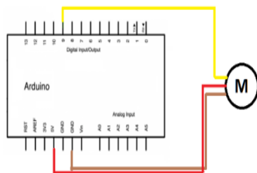
Рис. 14. Схема подключения серводвигателя SG90
