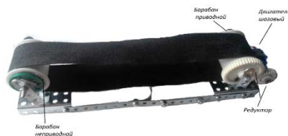
Рис. 15. Основные части модели конвейера ленточного
