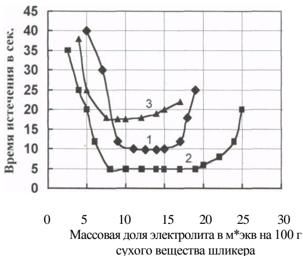
Рис. 6 Влияние различных электролитов (1 - NaOH; 2- Na 2 CO 3 ; 3 - Na 2 SiO 3 ) на вязкость (разжижаемость) глинистого шликера при постоянной его влажности [ 9]
