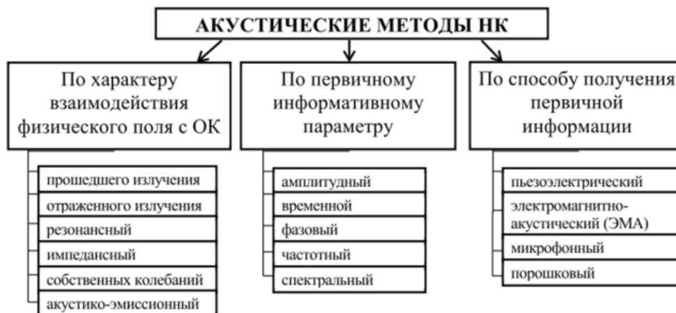
Рис. 15. Классификация акустических методов контроля по ГОСТ 18353-79
