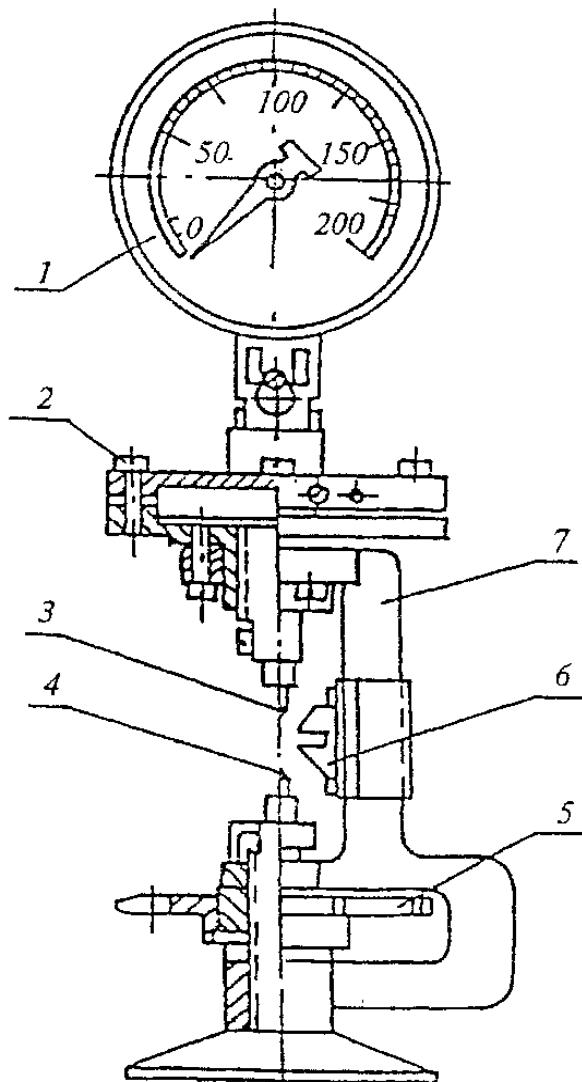
1 - манометр; 2 - гидравлическая мессдоза; 3 - верхний зуб; 4 - нижний зуб;
