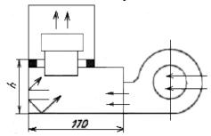
Рис.4.7 Приточная с боковым потоком система обдува
