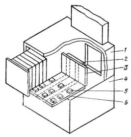
Рис.3.13 Компоновка приборного шкафа с использование ТТ
