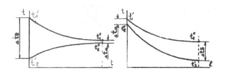
Рис. 1.9 К определению среднего температурного напора
