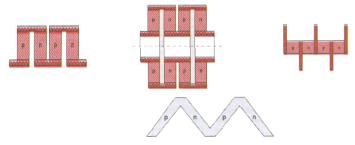
Рис. 3.3(а-г) Виды соединений термоэлементов в термобатарею
