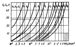
$(a_1-\delta_1,a_2-\delta_2,a_3-\delta_3-$  пластинчатые, ребристые, штыревые радиаторы при свободной конвекции;  $a_4-\delta_4-$  пластинчатые;  $a_5-\delta_5-$  ребристые;  $a_6-\delta_6-$  петельно-проволочные;  $a_7-\delta_7-$ жалюзивные;  $a_8-\delta_8-$  штыревые радиаторы при вынужденном движении воздуха со скоростями  $v=(2\div5)$  м/с)
