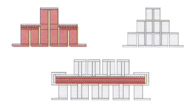
Рис. 3.4(а-в) Способы каскадного соединения термобатарей
