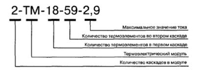
Рис. 3.6 Типы маркировок термоэлектрических модулей типа TM
