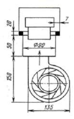
Рис. 4.5 Приточная с соостным потоком система обдува
