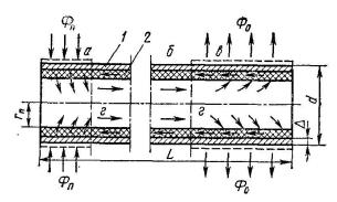
Рис.3.8 Схема тепловой трубы
