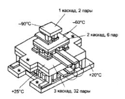
Рис. 3.5 Конструкция трехкаскадного модуля
