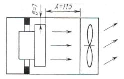
Рис. 4.3 Приточная система обдува
