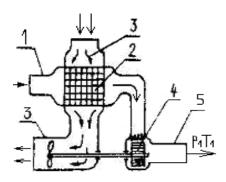
Рис. 3.14 Устройство турбохолодильного агрегата
