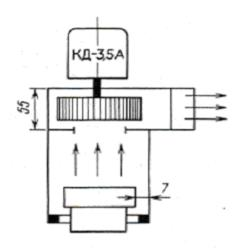
Рис.4.6 Вытяжная система обдува
