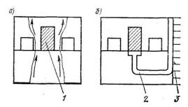
Рис.3.11 Охлаждение отдельного теплонагруженного блока или элемента: а – в условиях свободной вентиляции; б – с помощью тепловой трубы; 1 – теплонагруженный элемент; 2 – тепловая труба; 3 – наружное оребрение корпуса.
