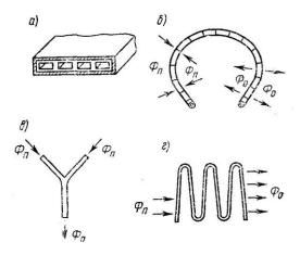
Рис.3.10 Тепловые трубы различного типа: а – плоская; б – гибкая; в – У-образная; г – змеевидная; Фп и Фо – подведенный и отведенный потоки теплоты.
