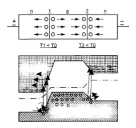
Рис. 3.1 Зонная диаграмма контакта полупроводника с металлом
