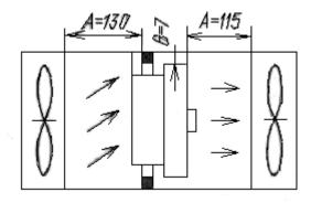
Рис. 4.4 Осевая двухвентиляторная приточно-вытяжная схема обдува
