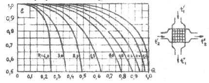
Рис. 1.10 Поправочный коэффициент  $\epsilon$  для теплообменника с перекрестным током
