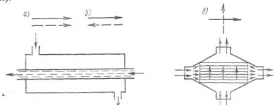
Рис. 1.7 Рекуперативные теплообменники с прямотоком (а), противотоком (б) и перекрестным током (в)
