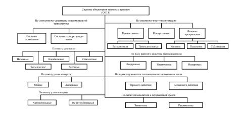
Рис. 1.1 Классификация систем обеспечения тепловых режимов РЭС
