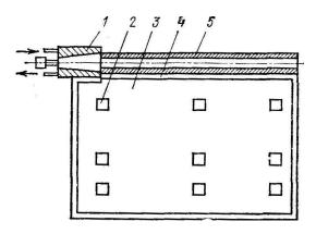
Рис.3.12 Охлаждение платы с микросхемами с помощью TT
