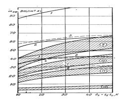
Рис. 2.6 Эффективный коэффициент теплоотдачи радиаторов в условиях свободного охлаждения.
