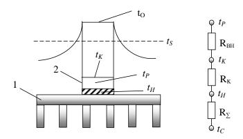
Рис. 2.4 Температурное поле радиатора 1 и прибора 2
