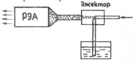
Рис. 1.4 Газоиспарительное охлаждение
