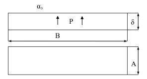
Рис. 2.3 Тепловая модель радиатора
