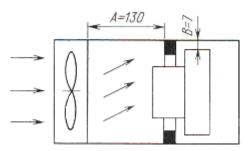
Рис. 4.2 Вытяжная система обдува
