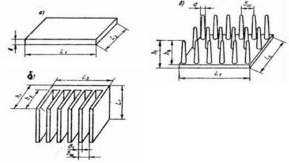
а- пластинчатый, б- игольчато- штыревой, в- пластинчатый
