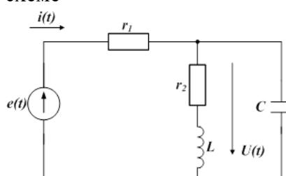
Задано:  $e(t) = 40 + 25\sin \omega t + 30\sin 2\omega t$  В;  $r_1 = 1$  Ом;  $r_2 = 1,5$  Ом;  $\omega L = 1$  Ом;  $1/\omega C = 14$  Ом.
