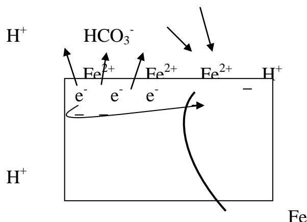
**Схема электрохимической коррозии железа в кислой среде**
