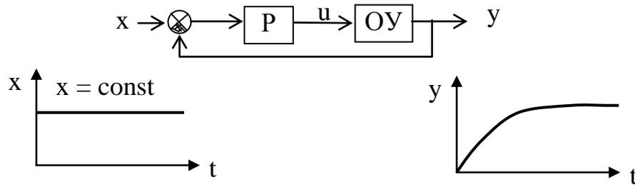
На схеме обозначены: P – регулятор, ОУ – объект регулирования, t – время.
