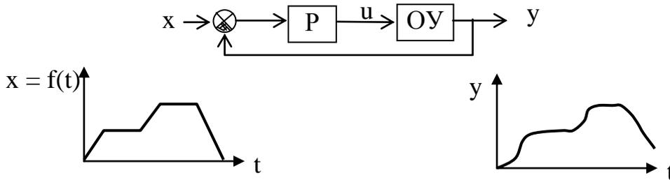
На схеме обозначены: P – регулятор, ОУ – объект регулирования, t – время.
