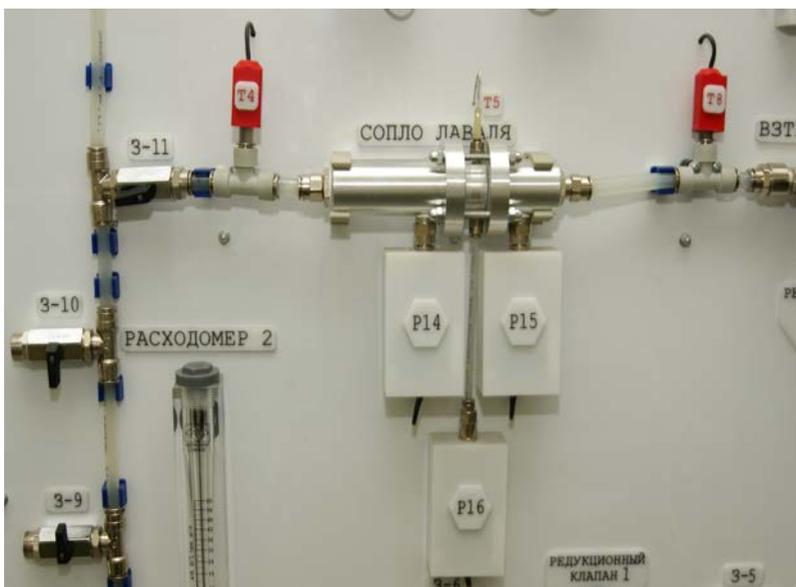
*Рис. 7. Участок исследования течения в сопле Лавалья.*
