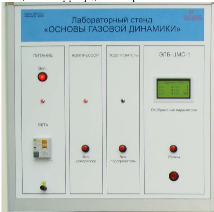
*Рис. 11. Блок управления включения стенда, подогревателя, вентилятора и компрессора.*
