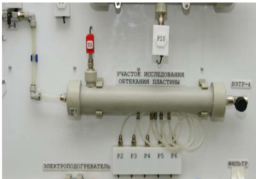
*Рис. 5. Участок изучения обтекания пластины.*
