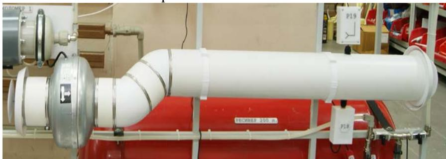
*Рис. 4. Участок исследования эпюр распределения скоростей (по величине динамического давления) при течении воздуха по трубопроводу круглого сечения с помощью трубки Пито.*
