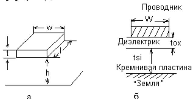
Рис. 3. Основные размеры соединительных проводников: а - проводник с диэлектрической изоляцией; б - проводник с изоляцией за счет p-n- перехода
