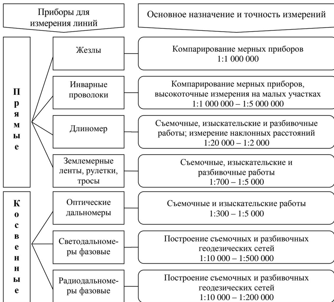
Рисунок 2.22 – Приборы для измерения линий
