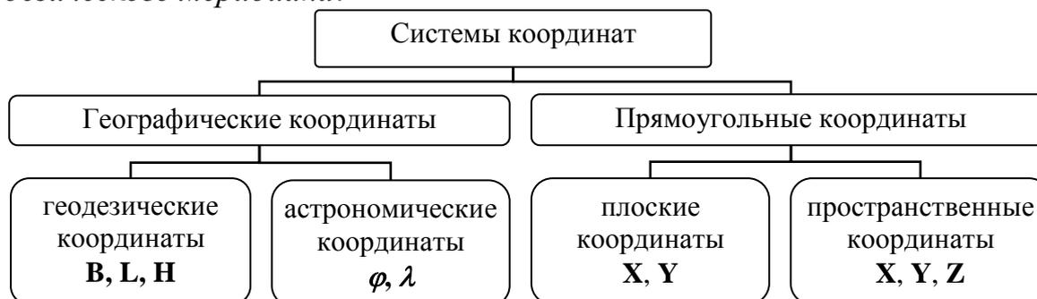
Рисунок 1.8 - Системы координат в геодезии
