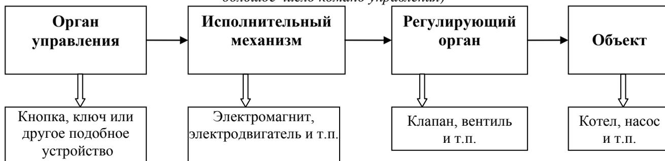
Рис. 5.2. Структурная схема системы дистанционного управления (телеуправления) [21]
