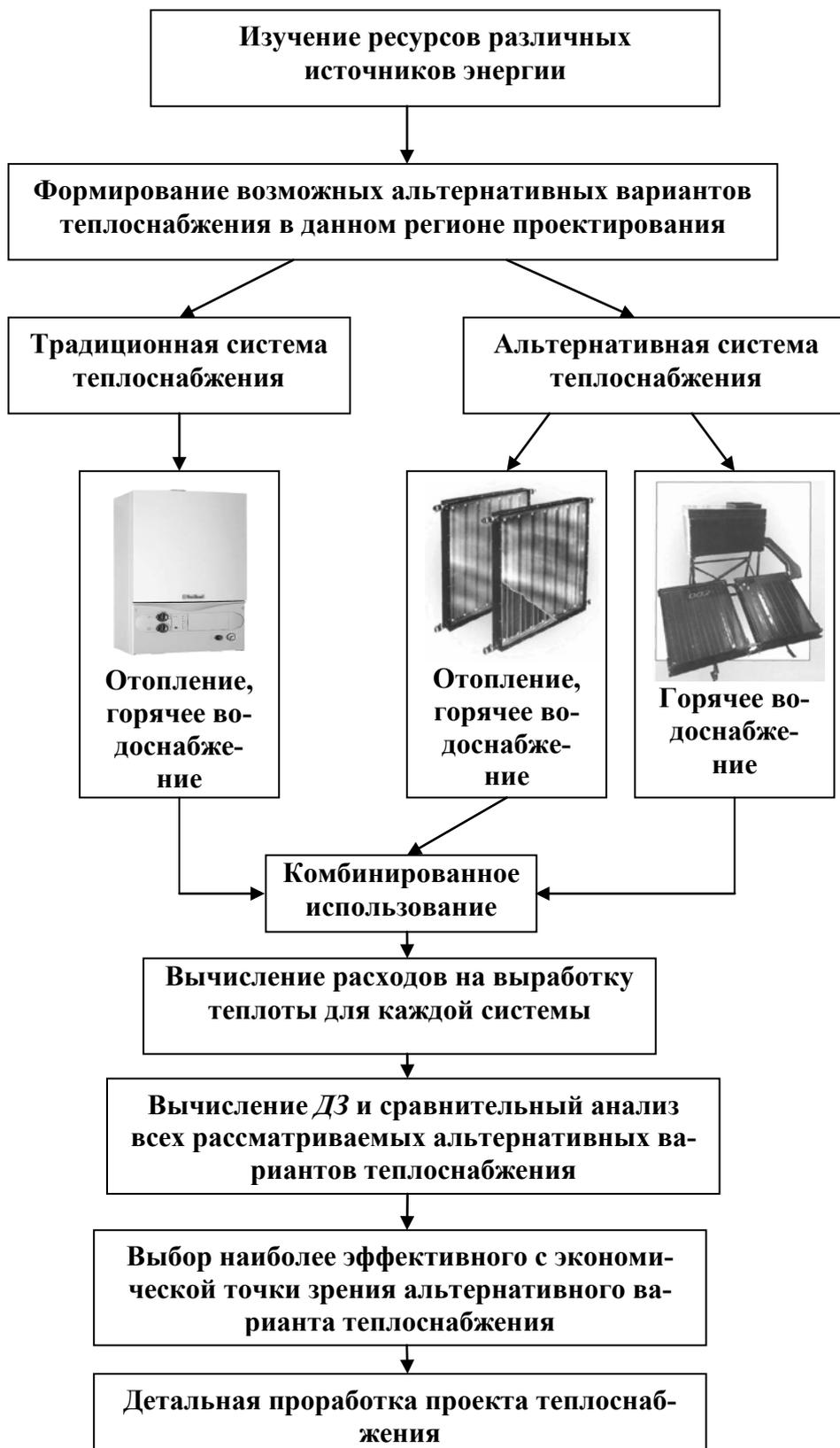
Рис. 4.3. Общая схема расчета и выбора системы теплоснабжения здания
