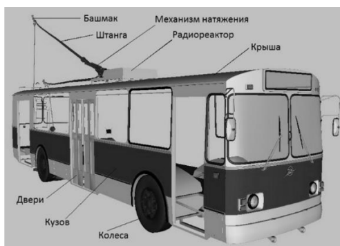
Рисунок 1.1 – Компоненты троллейбуса
