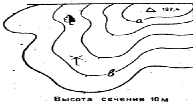
Рис.8.3. Определение отметки горизонтали по отметке точки
