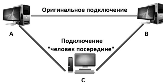
Рис. 1. Схема проведения атаки ARP-spoofing
