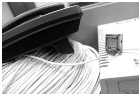
Рис. 11. Подключение трансформатора к телефонной линии
