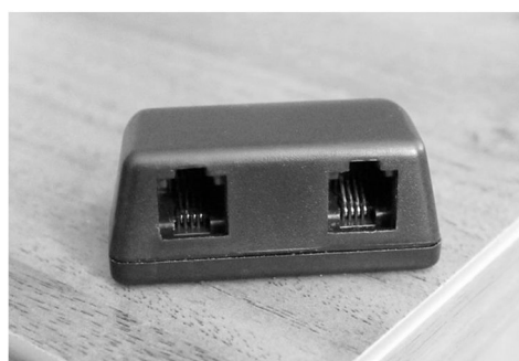
Рис. 4. Телефонный адаптер. RJ-переходник
