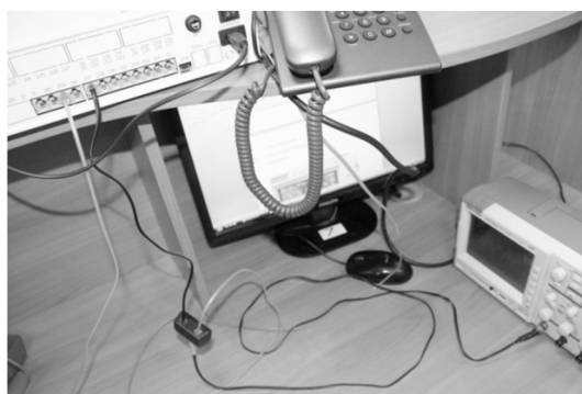
Рис. 5. Подключение осциллографа к телефонной линии
