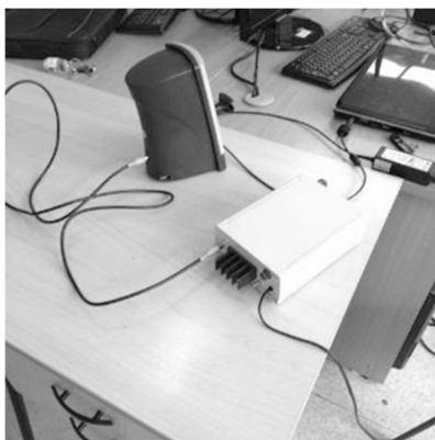
Рис. 3. Подключение RNG-test к акустическому излучателю
