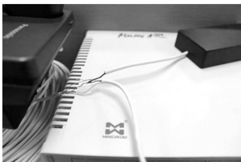
Рис. 10. Подключение телефонного радиосъёмника к телефонной линии
