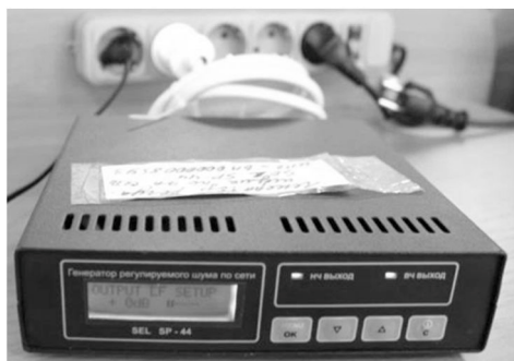
Рис. 12. Настройка генерации ВЧ-сигналов в генераторе SELSP-44
