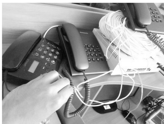
Рис. 9. Подключение параллельного телефона к телефонной линии
