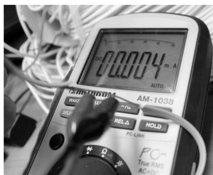
Рис. 7. Последовательное подключение мультиметра к телефонной линии
