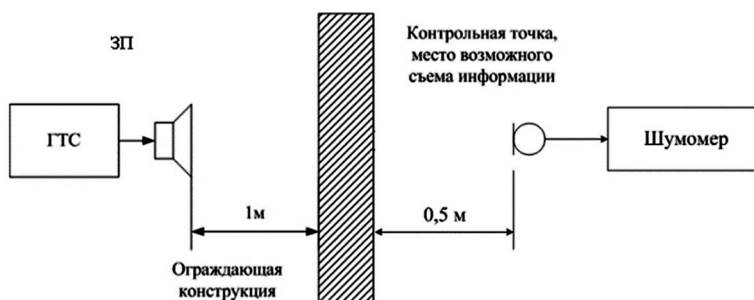
Рис. 3. Схема проведения измерения уровней шума и смеси сигнал + шум для акустического КУИ
