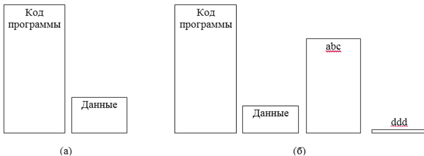
Рис. 5.8. Процесс имеет два сегмента: кода и данных (а) Сегменты процесса перед отображением файлов в адресное пространство; (б) Процесс после отображения существующего файла abc в один сегмент и создания нового сегмента для файла ddd
