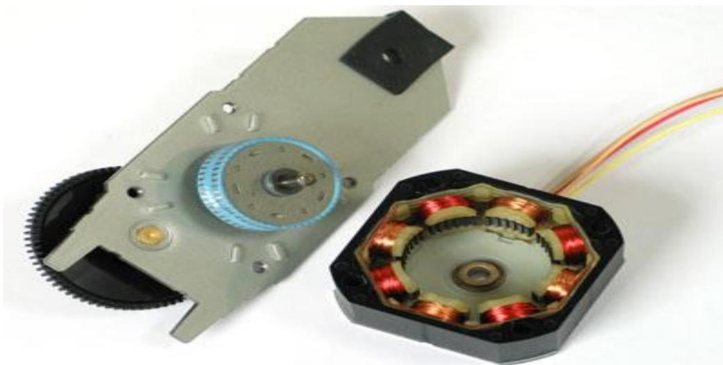
Рисунок 25 - Устройство статора шагового двигателя
