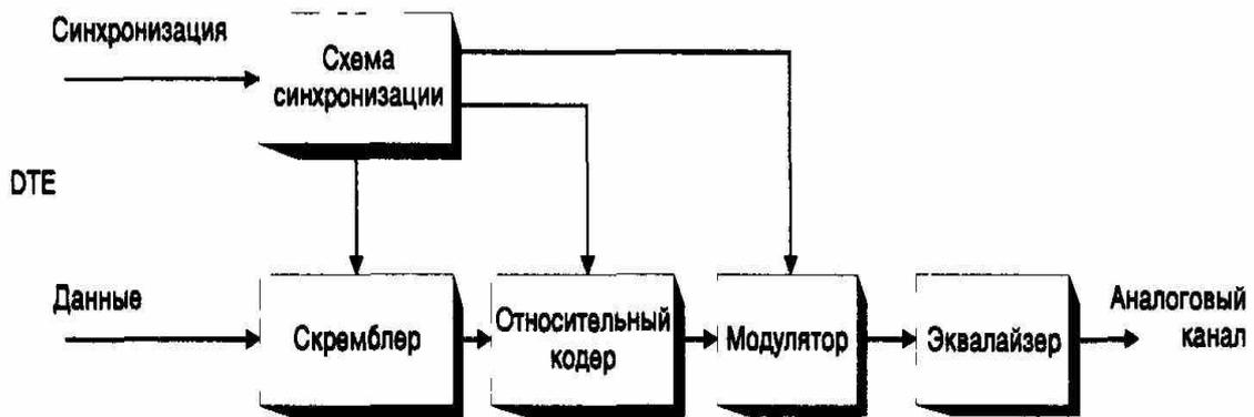
Рисунок 3 - Схема передатчика синхронного модема
