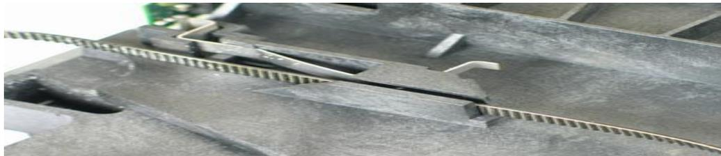
Рисунок 20 - Место крепления ремня к сканирующей каретке
