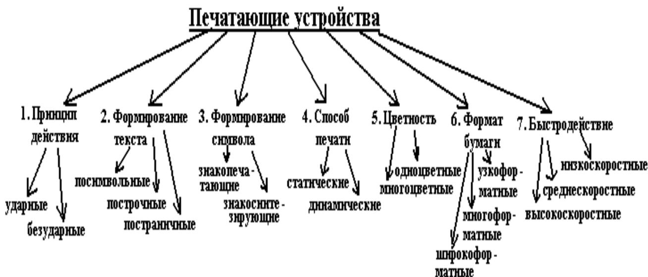
Рисунок 1 - Классификация печатающих устройств
