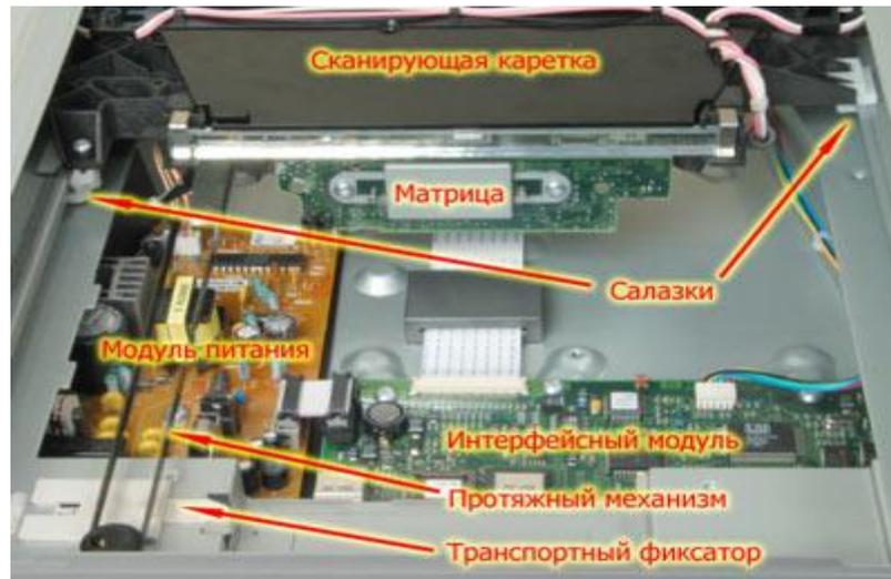
Рисунок 13 - Расположение основных функциональных узлов сканера
