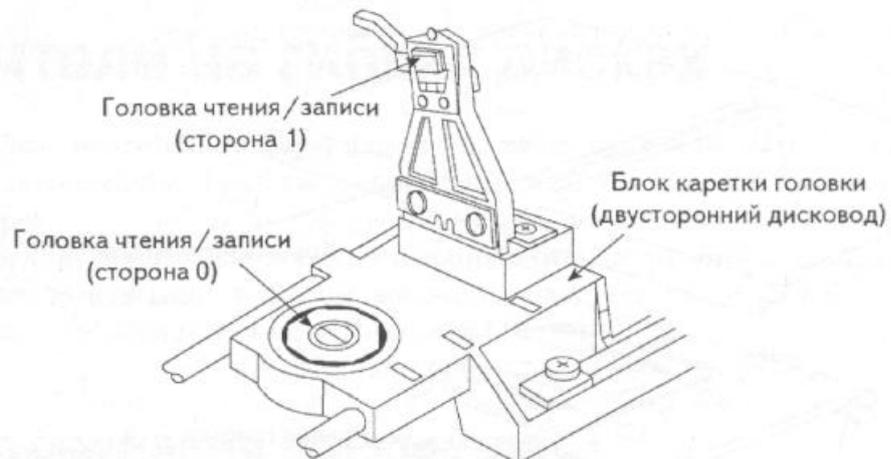
Рисунок 2 - Блоки головок в двустороннем дисковом.
