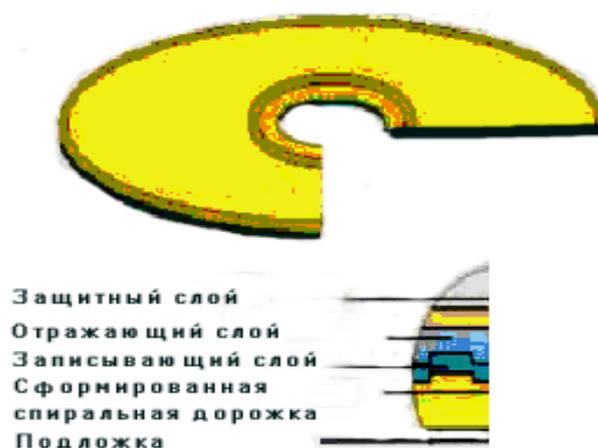
Рис. 1 - Структура оптического перезаписываемого диска CD-RW
