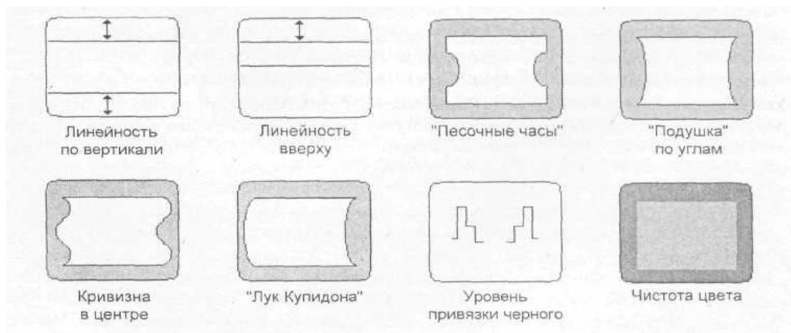
Рисунок 5 Обозначения дополнительных регулируемых параметров изображения
