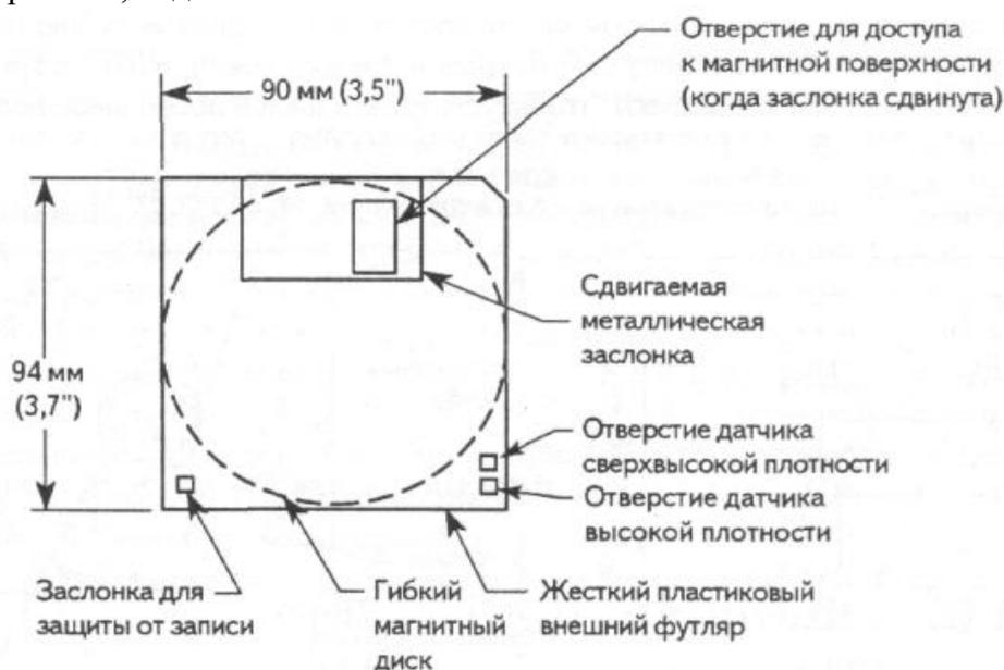
Рисунок 8 - Конструкция дискеты диаметром 3,5 дюйма
