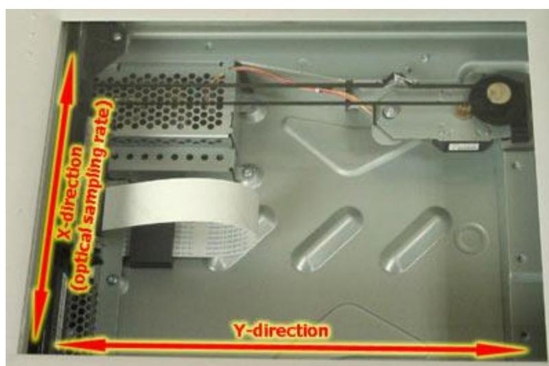
Рисунок 23 - Оптическое разрешение сканера – направление X, а его механическое разрешение – направление Y
