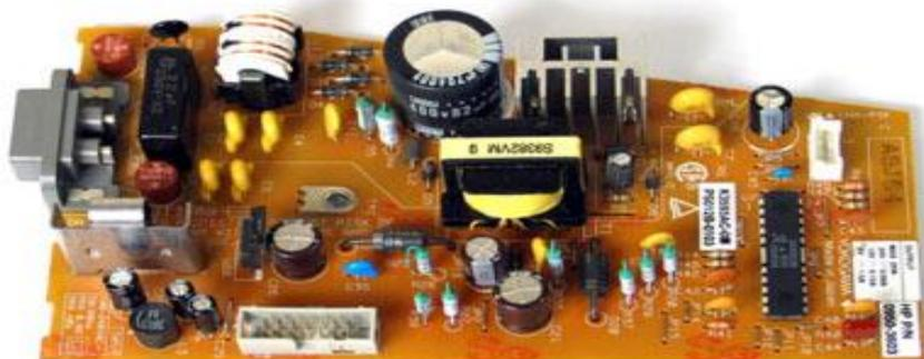
Рисунок 26 - Блок питания сканера
