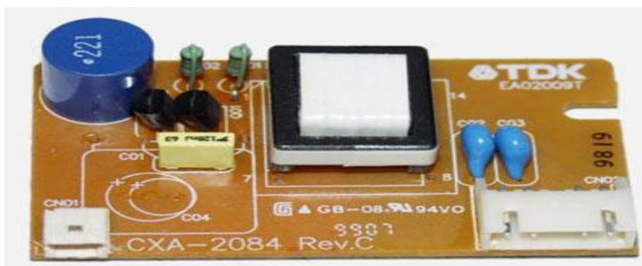
Рисунок 15 - Высоковольтный модуль
