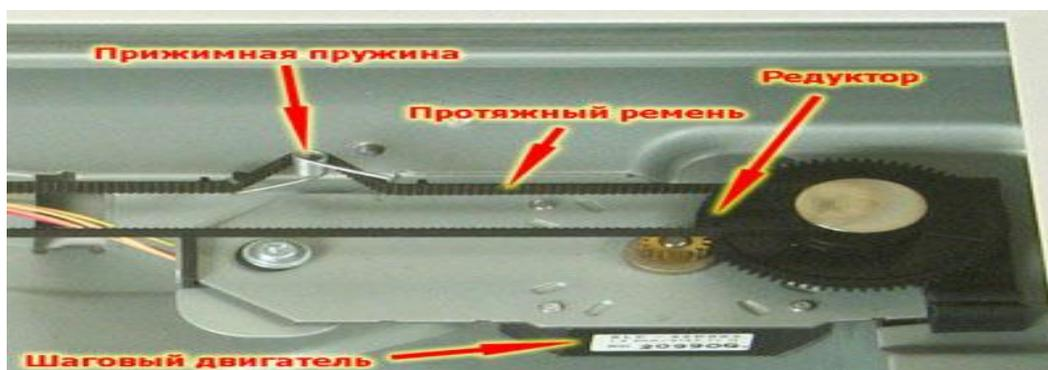
Рисунок 21 - Элементы протяжного механизма
