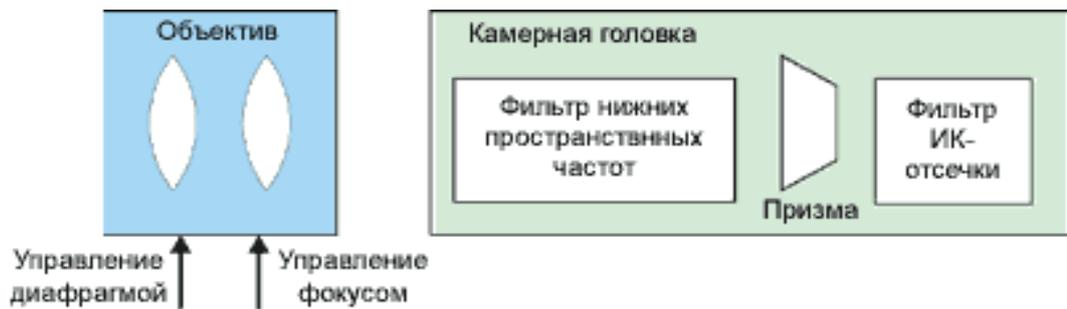
Рис. 4. Оптическая часть видеокамеры
