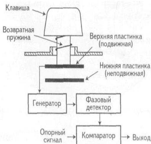
Рисунок 5 - Клавиша с емкостным датчиком
