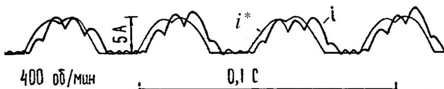
Рис.4.7. Осциллограммы сигналов при частоте вращения  $400$  об/мин
