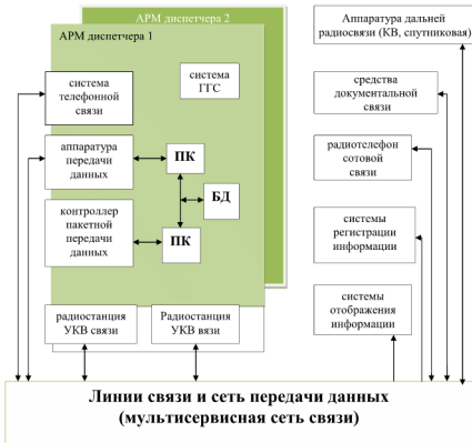
Рис. 6.2. Комплекс технических средств центрального диспетчерского пункта связи
