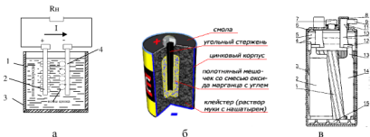
Рис. 1.28. Источники питания: а) схема гальванического элемента: 1 – клейстер; 2 и 4 – стержни; 3 – корпус; б) устройство гальванического элемента; в) схема частей аккумулятора: 1 – сепаратор; 2 – положительная пластина; 3 – корпус; 4 – уровень электролита (макс/мин); 5 – свободное пространство; 6 – уплотнение крышки, непроницаемое для электролита; 7 – заглушка в отверстии для заливки; 8 – уплотнение полюсного штыря; 9 – перемычка; 10 – полюсный штырь; 11 – уплотнение полюсного штыря; 12 – гребенка; 13 – выступ аккумуляторной пластины; 14 – отрицательная пластина; 15 – пространство для отложения шлама
