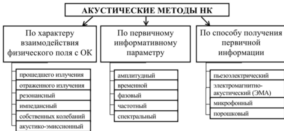
Рис. 15. Классификация акустических методов контроля по ГОСТ 18353-79
