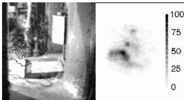
Рис. 11. Способ представления результатов измерения распределения радиоактивности — радиоактивное пятно на полу помещения
